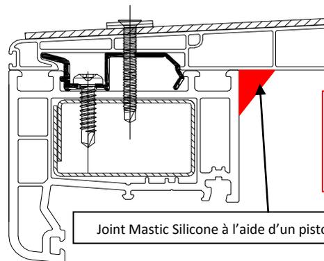
Joint Mastic Silicone à l'aide d'un pistolet
