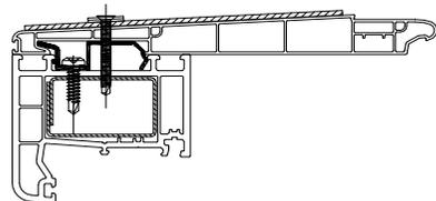
Fixer la sous face du coffre en la vissant sur la traverse haute de menuiserie
