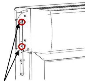
Etanchéité à l'aide d'un mastic silicone au niveau du clipage de la patte feuillard sur la joue.
