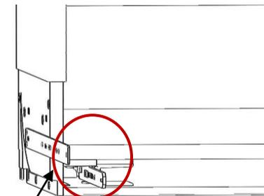
Etanchéité à l'aide d'une mousse EPDM (Ep 2mm) entre la joue et l'éclisse.
